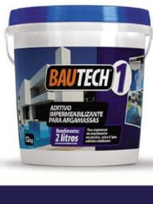
É um aditivo impermeabilizante à base de silicatos que ao entrar em contato com o cimento da estrutura no momento da hidratação forma cristais permanentes, que entopem os poros da estrutura impedindo a penetração da água de maneira irreversível e permanente, promovendo impermeabilidade ao revestimento.
